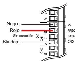
Conexiones del sensor 2536 a instrumentos Signet
