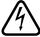
Riesgo de descarga eléctrica
